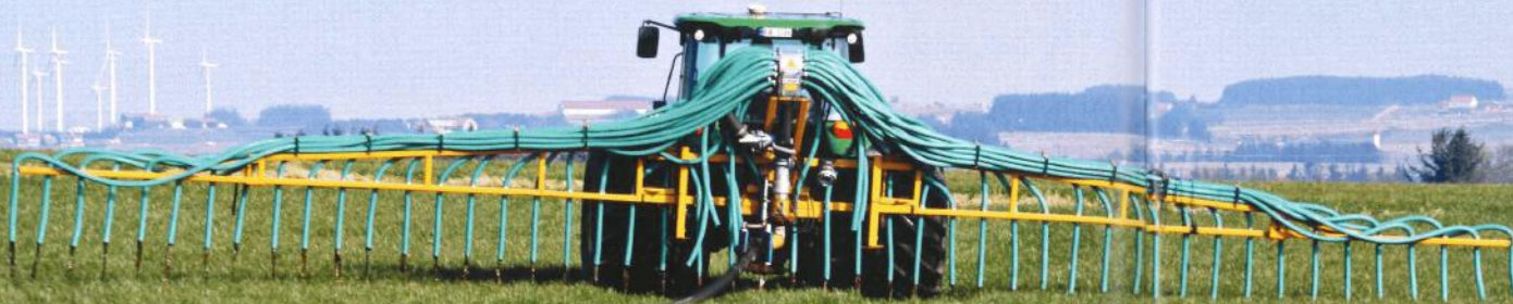
EFFEKTIV VÅRGJØDNING: Med slangesprederutstyr gjødsler Rune Haugland med opp mot ti tonn vannblanda husdyrgjødsel tidlig om våren. Dermed utnyttes næringsstoffene gjennom vekstsesongen. (Illustrasjonsbilde fra Jæren 18. mars 2015)
